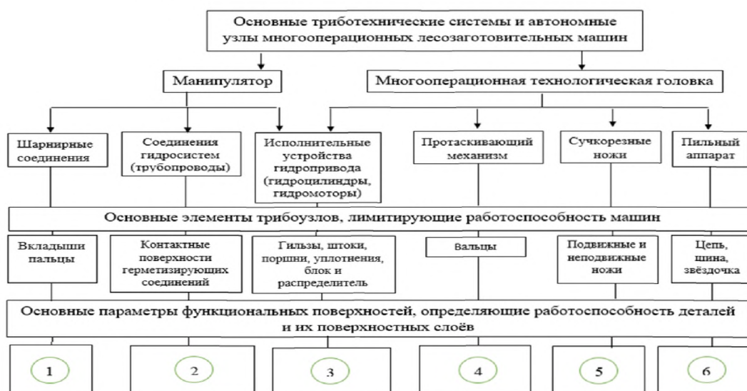
Рисунок 1.2 - Основные триботехнические узлы манипулятора и рабочих органов многооперационных машин [116]
