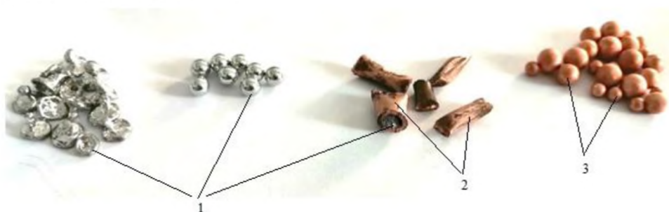
Рисунок 2.9 – Элементы металлической фазы нового композиционного материала: 1- легкоплавкий материал; 2- капсулы в виде цилиндра, изготовленные путём деформации оснований; 3 – сферические капсулы, заключенные в оболочку, выполненную электрохимическим способом.
