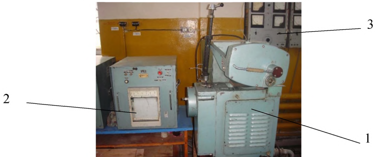
Рисунок 4.7- Машина СМЦ-2 с набором измерительного оборудования: 1- испытательная машина СМЦ-2; 2- потенциометр ПСР-49; 3- потенциометр ПСР-2
